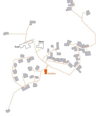
Pour ne pas perturber la distribution d'énergie, la chaudière fioul démarre automatiquement dès que la température de l'eau du réseau
